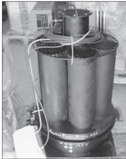
Bild 4: Prototyp eines elektrostatischen Feinstaubabscheiders zum Aufbau auf den Kamin (Bilder: M. Berntsen, Norwegen).
