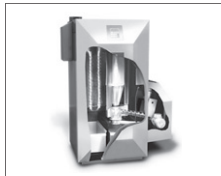
Bild 2: Pelletsessel mit automatischer Zündung und zweistufiger Verbrennung auf einem halbkugelförmigen Kipprost (Bild: Liebi LNC).
